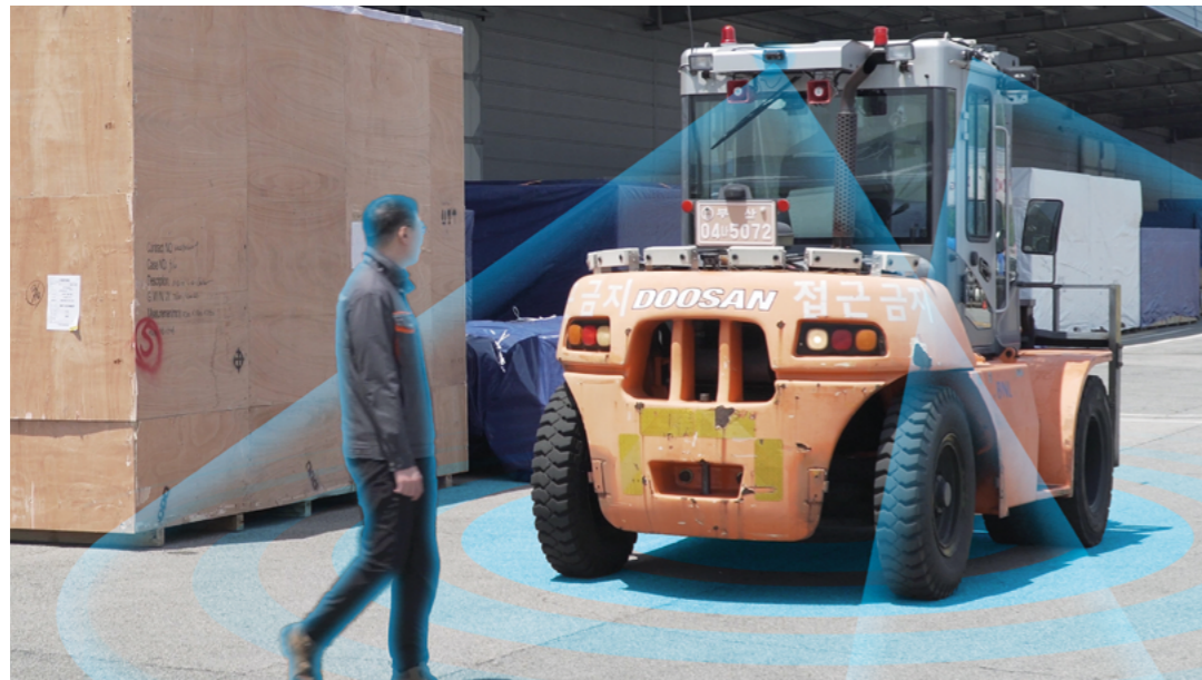
<무스마의 어라운드뷰 시스템으로 후면 사각지대에 있는 작업자를 인식하는 모습 >
